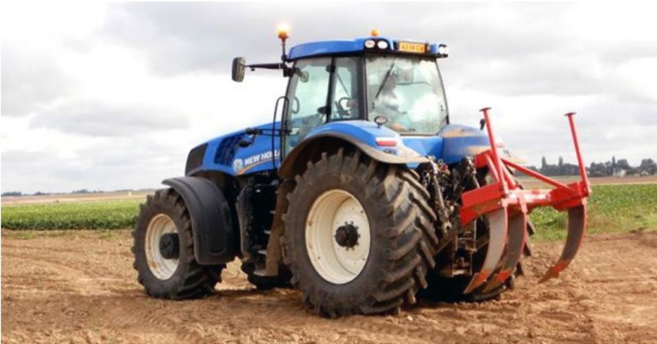
Sous-soleur utilisé pour restructurer les sols en profondeur tiré par un tracteur New Holland de 420 chevaux.
