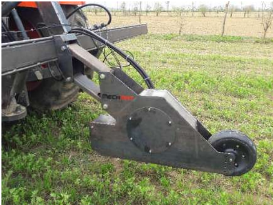
Vue du premier élément de broyeur MECAMAT Détail de la coupe au sol entre deux rangs de céréales
