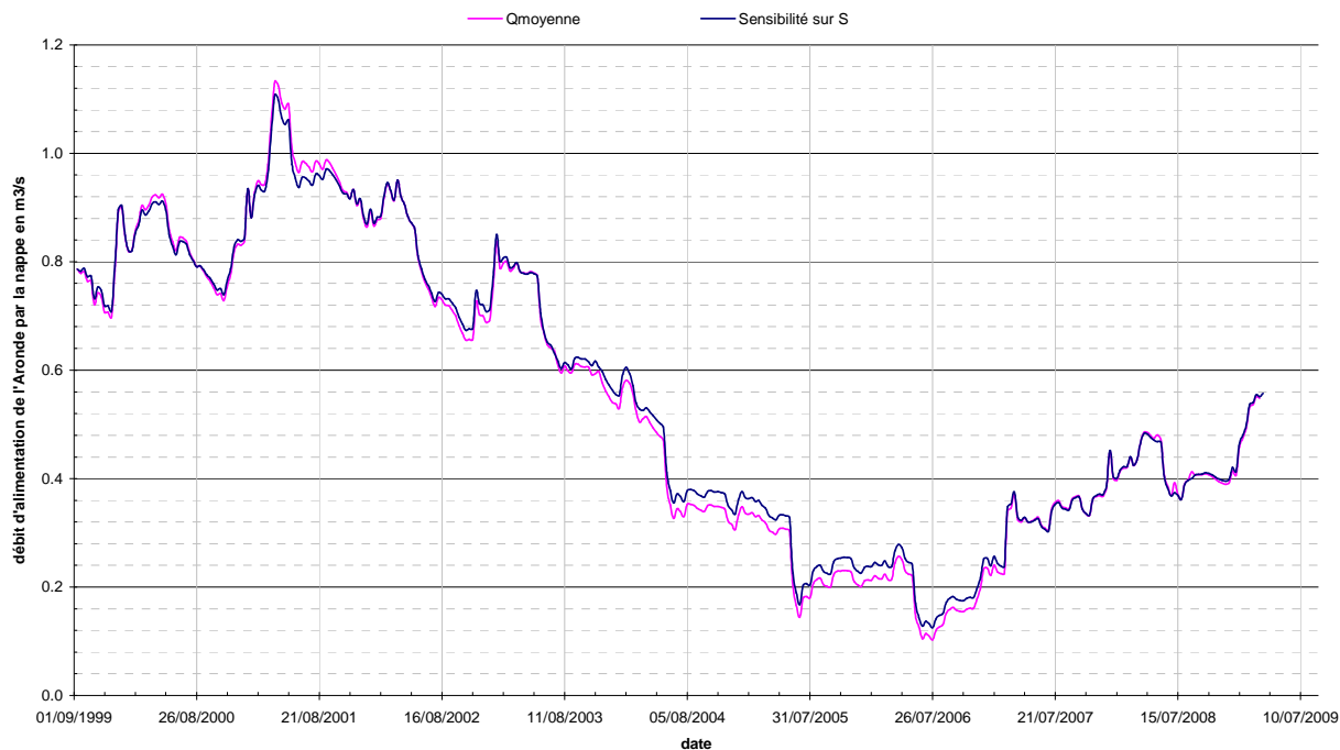
Figure 42 : sensibilité des débits d'alimentation de l'Aronde par la nappe à une variation du coefficient d'emmagasinement
