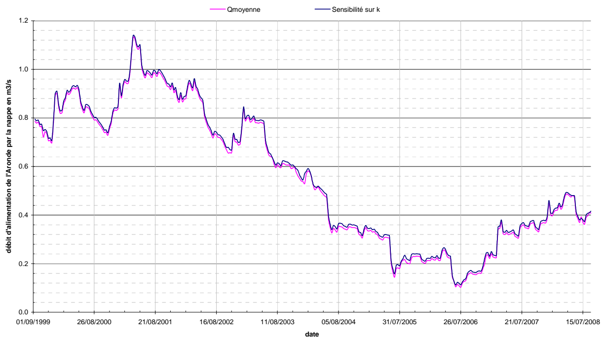
Figure 43 : sensibilité des débits d'alimentation de l'Aronde par la nappe à une variation de la conductance de la rivière
