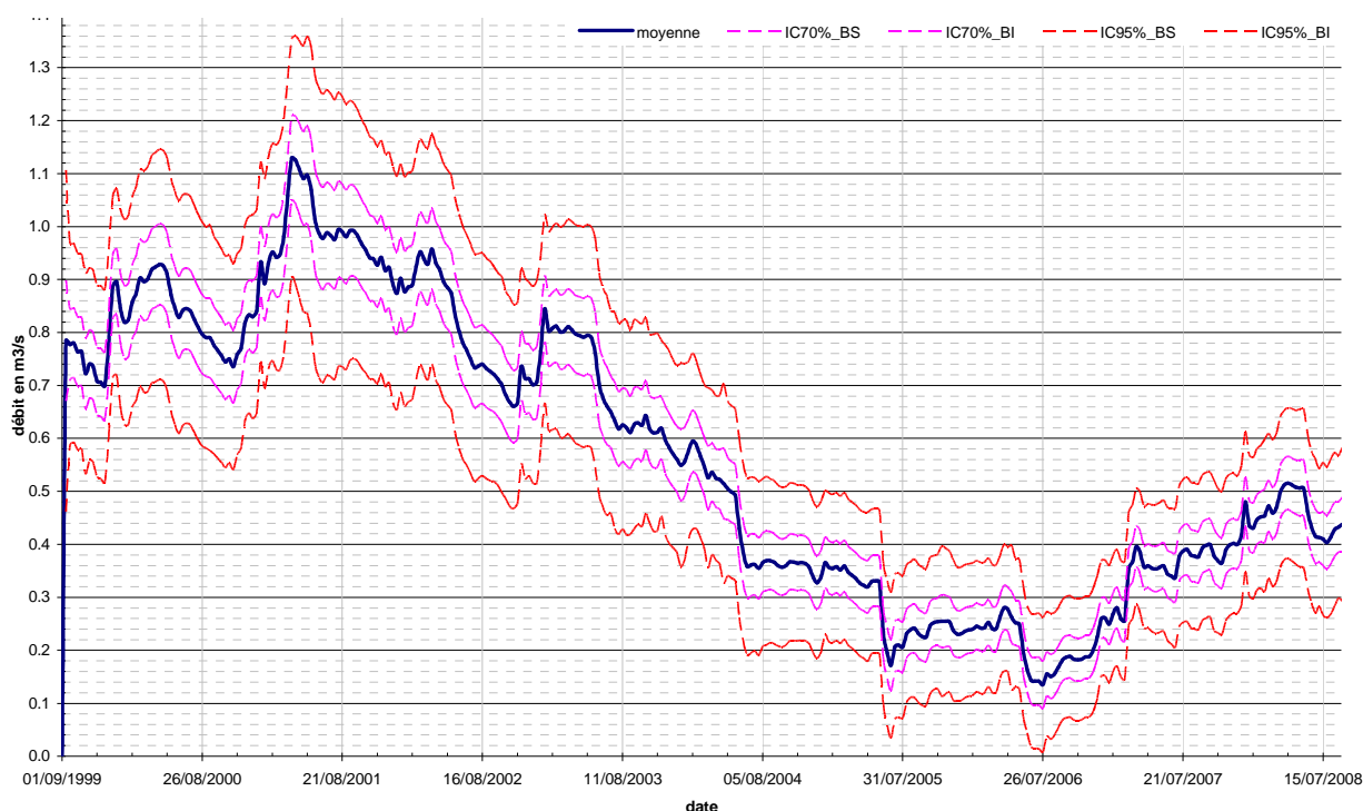
Figure 47 : Intervalles de confiance sur le calcul du débit d'alimentation de l'Aronde par la nappe
