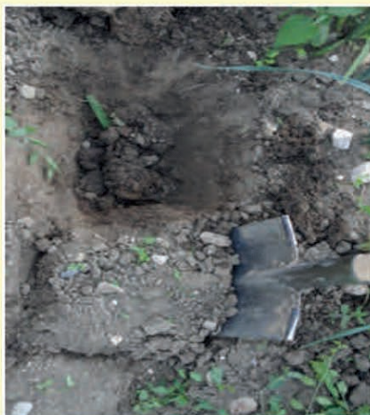
Figure 2 : Prédécouper le volume de sol à analyser
