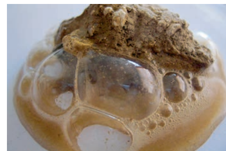
Sol de limon calcaire. Forte effervescence.
