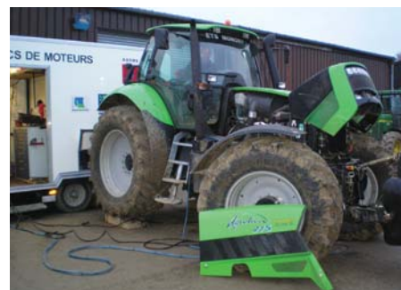
Le banc d'essai permet de faire le bilan de santé de votre tracteur.
