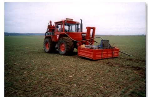
Réalisation de sondages sur des parcelles agricoles
